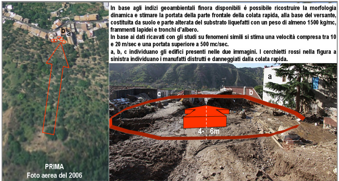
Figura 9: a sinistra è illustrato il versante prima della frana (foto aerea del 2006). La freccia indica il percorso della colata rapida di fango e i cerchi rossi individuano i manufatti distrutti e danneggiati dal flusso fangoso. A destra è proposta la ricostruzione della morfologia dinamica del fronte del flusso fangoso quando ha investito i manufatti alla base del versante.
