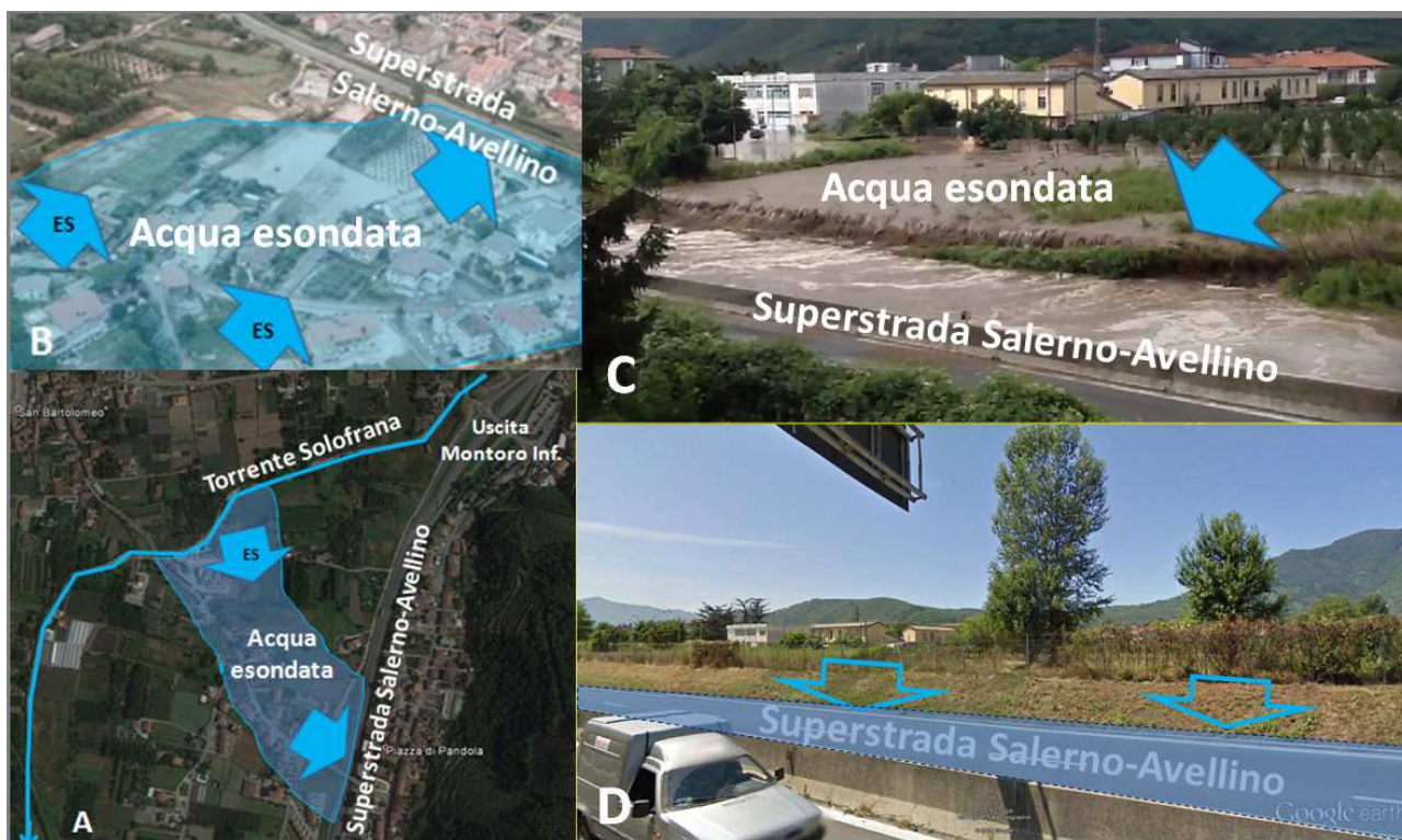
Figura 11: Esondazione del Torrente Solofrana in sinistra orografica all'altezza dello svincolo di Montoro Inferiore della superstrada Salerno-Avellino. Immagine A: individuazione su foto satellitare dell'area interessata dall'esonazione e dall'allagamento della superstrada. Immagine B: foto tratta dalla rete che evidenzia l'esonazione in sinistra orografica e la conseguente invasione della corsia verso Salerno della superstrada. Immagine C: l'acqua esondata invade la carreggiata verso Salerno. Immagine D: Il tratto di superstrada (da street view di Google Earth) che è stato allagato.
