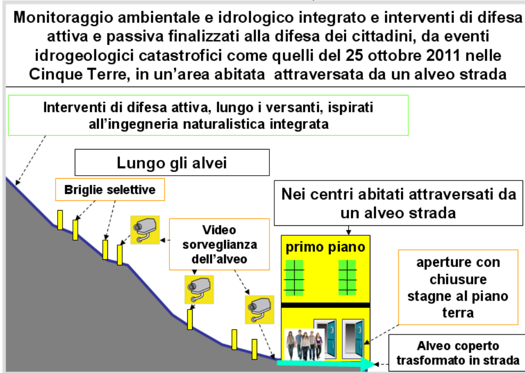
Figura 9: schema degli interventi di difesa attiva e passiva realizzabili per mitigare gli effetti sull'ambiente naturale e urbanizzato e per garantire la sicurezza dei cittadini.
