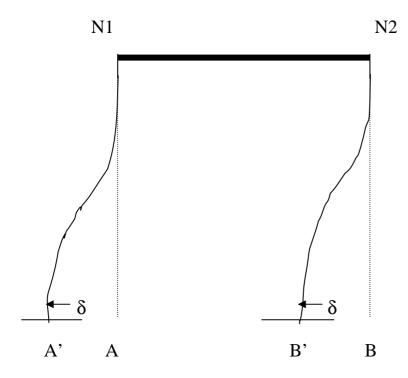
Il punto fondamentale è il seguente: il traverso N1-N2, per la sua inerzia, non segue immediatamente lo spostamento del suolo, facendo si che la struttura si deformi come riportato sul disegno precedente.
