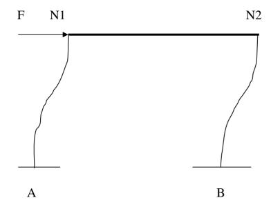
In altri termini, possiamo affermare che un terremoto, in termini di azione sulla nostra struttura, è perfettamente analogo alla azione di una forza orizzontale applicata nel baricentro delle masse.
